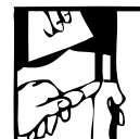
5 Corte o excesso depois de, no mínimo, 2 (duas) horas da aplicação. A cura total ocorre depois de 24 horas.
