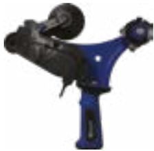
Usado na aplicação de fitas teladas de até 50 mm de largura em tratamento de juntas planas ou de cantos internos.
