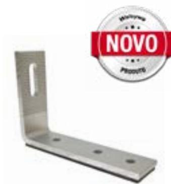
Usado na fixação dos trilhos em telhados construídos com telhas metálicas trapezoidais. A fixação com 3 parafusos garante alta resistência e distribuição de peso, além do revestimento de borracha na parte inferior que promove excelente vedação. É fixado na onda alta da telha.
